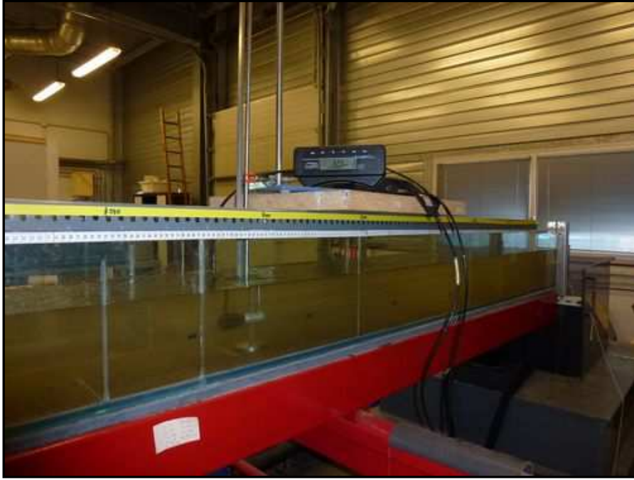
Photo 1 : courantomètre sur perche dans le canal d'essai
